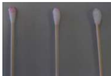
Fig. 4: Immagine che dimostra i risultati visivi del tampone passati all'interno dell'unità base dopo il ciclo di disinfezione effettuato con il dispositivo surrogato contaminato. S-D: tampone passato dopo che l'interno del surrogato è stato caricato con lo sporco, tampone passato dopo che l'esterno del surrogato è stato caricato con lo sporco, tampone di controllo negativo passato prima del ciclo di disinfezione.
